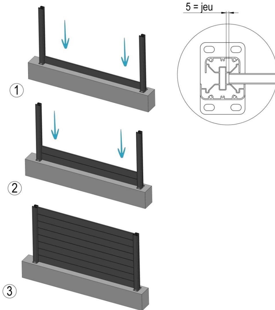
Enfiler la première lame jusqu'à être en appui sur la platine, enfiler ensuite les autres lames une par une jusqu'à être en appui sur la précédente.
